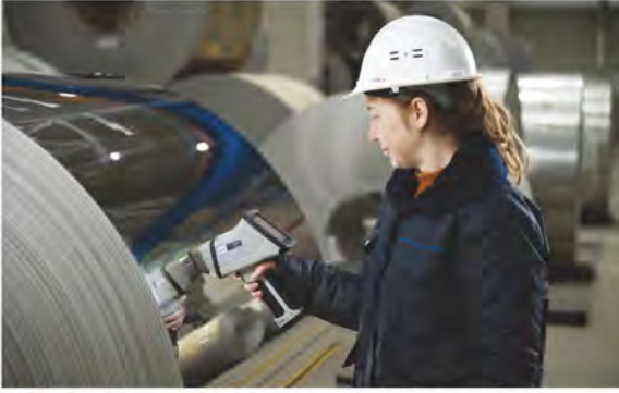
03. Positive Material Identification Pozitif Malzeme Tanımlama
