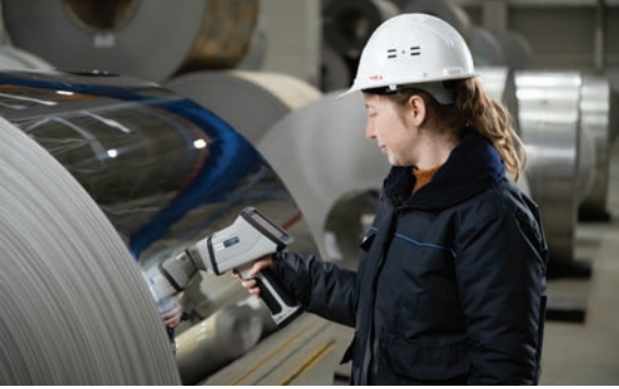
03. Positive Material Identification Pozitif Malzeme Tanımlama
